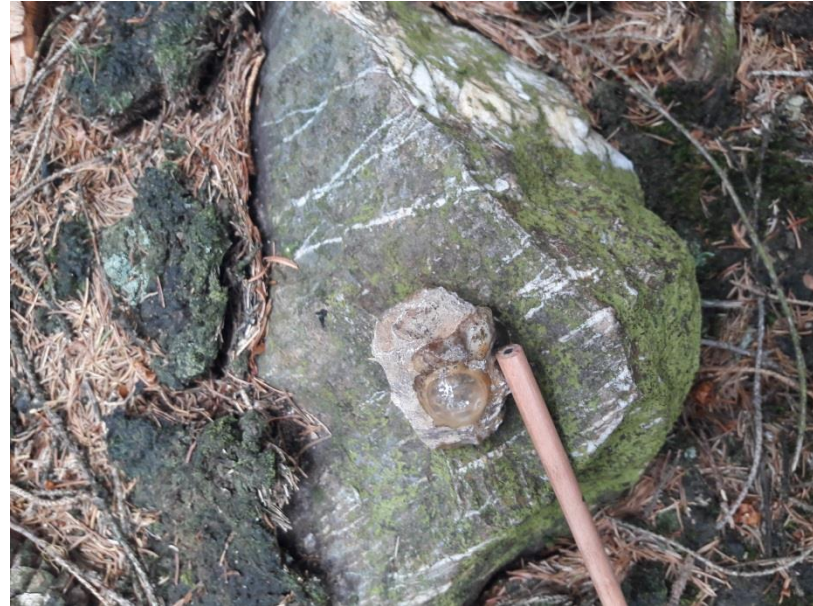
X2: Kalksteinstücke, Salzsäuretest belegt Karbonatgehalt (Bläschenbildung), Lesesteine im Bereich WEA02 – Eintrag aus früherem Wegebau oder im Untergrund anstehend?
